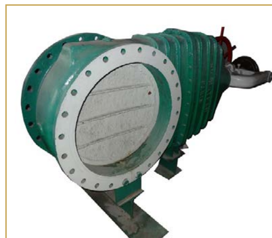
ZASUWA DN 800 PN6 produkcji francuskiej firmy Société Rateau à Paris. Urządzenie to pracowało niezawodnie aż 70 lat.
