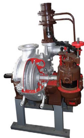
FRAGMENT TURBINY , wyprodukowanej w 1938 r. przez firmę Société Générale de Constructions Electriques et Mécaniques Alsthom – inwestora elektrowni Stalowa Wola.
