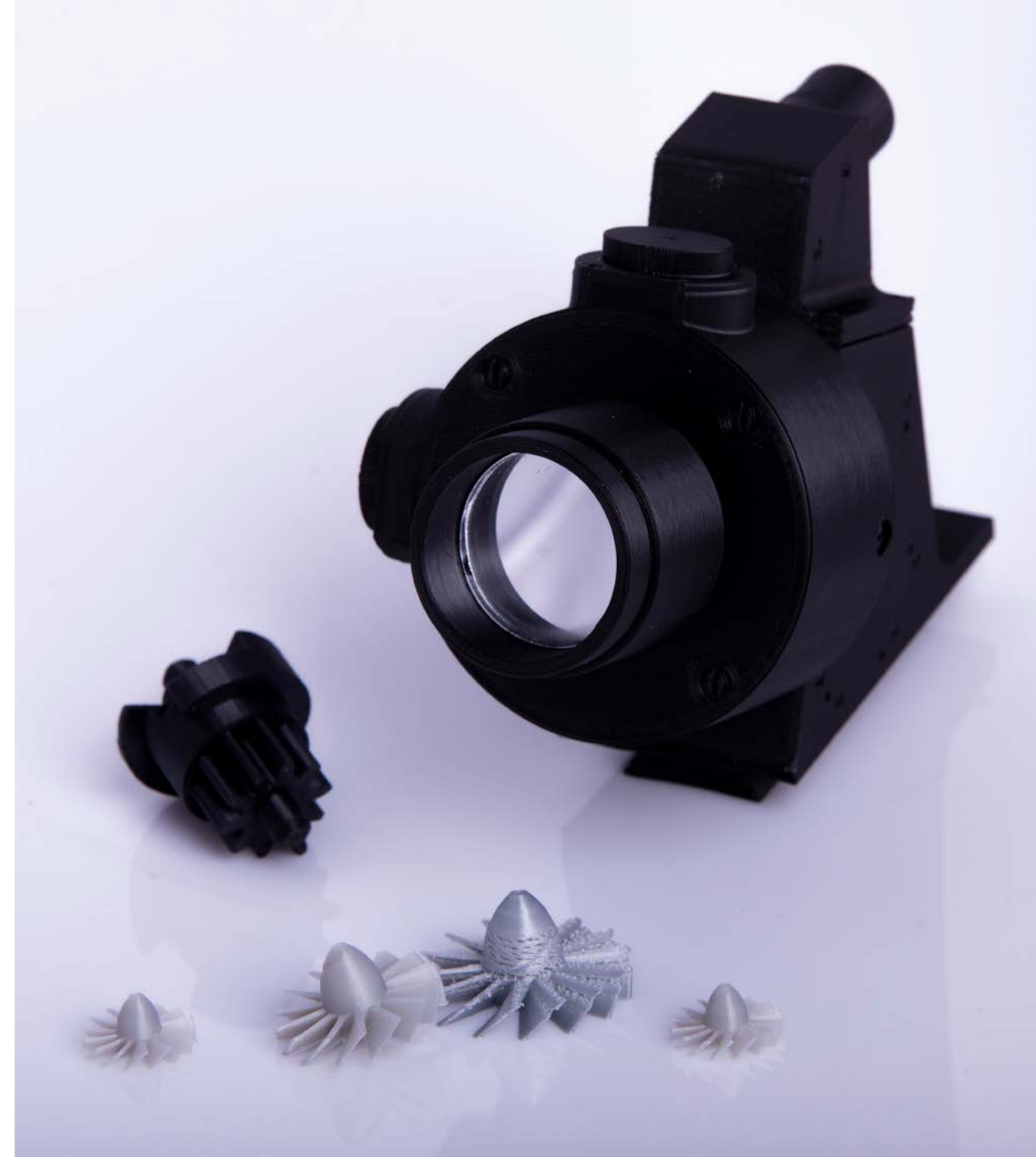
▲ Prototyp celownika do armaty przeciwpancernej wz. 36 kaliber 37 mm, fot. Marcin Torbiński
