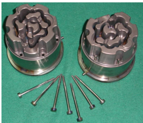
Rys. 9. Wkładki matrycowe po procesie azotowania i nakładania powłoki metodą PVD Fig. 9. The casting dies after nitriding process and PVD deposition
